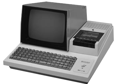
写真1 シャープが1978年12月に発売したMZ-80K 後継モデルのMZ-80K2Eは、「MZクリーンコンピュータ10万台突破」を記念して発売された。MZ-80KとMZ-80K2Eの外観はほとんど同じだが,ディスプレイのきょう体の色(MZ-80Kは赤,MZ-80K2Eは深緑)やキーボードの色が異なる。
