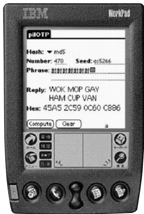
写真1 Palm OS互換機で利用可能なOTP計算機 文字が化けるのはご愛敬。日本語に対応していないだけで動作に支障はない。
